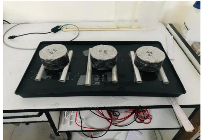
Fig. 4.2.10 Sorptivity test apparatus
